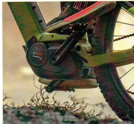
Bloc moteur d'un VAE (modèle Bosch).
